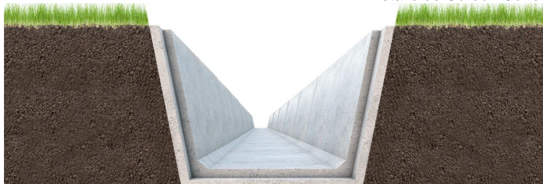
Detalle de Canal de Hormigón Armado – Sistema de Desagüe Pluvial
